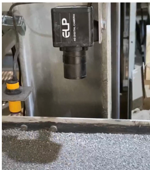
Vibrationsförderer des Eddy Current Separators (inkl. Kamera)
